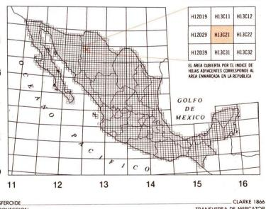
\_TRANSVERSA DE MERCATOR \_\_UTM A CADA 1000 m. NORTEAMERICANO DE 1927 \_\_NIVEL MEDIO DEL MAR PROCEDIMIENTO DE COMPILACION PRIMERA EDICION \_FOTOGRAMETRICO PRIMERA IMPRESION
