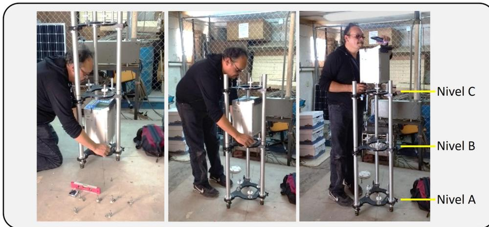
Figura 4. Levantamiento de gradiente vertical en 3 niveles con gravímetro relativo.
