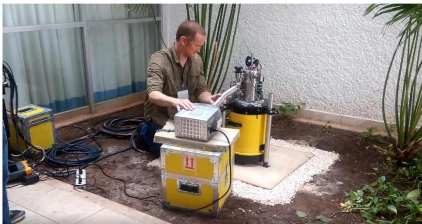
Las EGA ayudan a unificar los levantamientos gravimétricos locales en un sistema de medición congruente, lo cual permite mantener la homogeneidad de datos al momento de incorporarlos en mapas de la intensidad del campo de gravedad con cobertura nacional.
